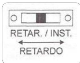
**4** Na placa eletrônica selecionar a chave na posição desejada: **Opção Retardo:** O equipamento desligará os faróis 5 minutos após a volta da energia. **Opção instantânea:** O equipamento desligará os faróis na volta da energia
