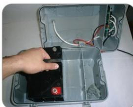
**3** Coloque a bateria no centro da divisão, tomando o cuidado de conectar o fio preto ao terminal negativo (-) e o fio vermelho ao terminal positivo (+)
