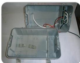
**2** Desencaixe a tampa tomando o devido cuidado ao retirá-la para não romper as ligações (fios) entre a placa eletrônica e os projetores
