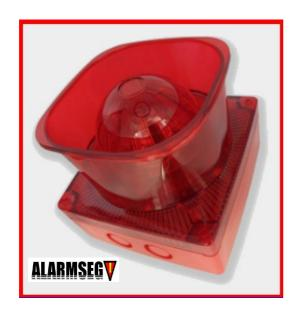
O sinalizador é um dispositivo de alarme com sirene piezoelétrica de alta intensidade, strobe (conjunto de 12 pilotos tipo LED de alto brilho) e baixíssimo consumo para operação em 24 volts. Possui proteção contra inversão de polaridade e pode ser usado diretamente em linhas de comando supervisionadas.
