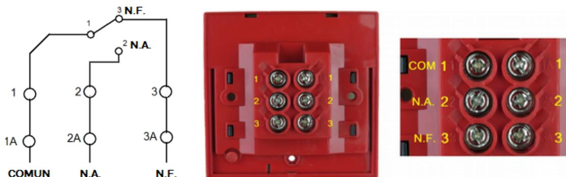
Normalmente Aberto (N.A.) entre 1 e 2, ou seja, se utilizar os bornes 1 e 2, ao quebrar o vidro, o acionador manual / botoeira irá enviar energia para algum dispositivo que nele esteja ligado. Se utilizar os bornes 1 e 3 (N.F.), ao quebrar o vidro, o acionador manual /botoeira irá parar de mandar energia a algum dispositivo que esteja ligado à ele.
