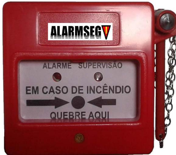
Acionador manual é um dispositivo essencial em sistemas de detecção e alarme de incêndio. Sua função primária é permitir que ocupantes de um edifício possam iniciar manualmente o processo de evacuação ou alerta em caso de detecção de fumaça, calor ou o outro sinal de incêndio. Os acionadores devem ser instalados em altura acessível a todos os ocupantes, incluindo pessoas com mobilidade reduzida. Deve-se evitar instalações em locais onde possam ser obstruídos ou danificados acidentalmente.
