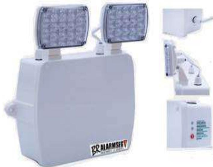
Bloco autônomo de emergência, com 2 faróis de LEDs tipo SMD, direcionáveis. Indicado para ambientes externos, empoeirados, úmidos, etc. Pode ser em indústria (refrigerado por exemplo), comércio, entre outras aplicações. Possui grau de proteção IP66 no invólucro e faróis (totalmente protegido contra poeira e contra jatos potentes de água) . Proteção IP68 (totalmente protegido contra poeira e contra submersão em água) para fonte eletrônica interna.
